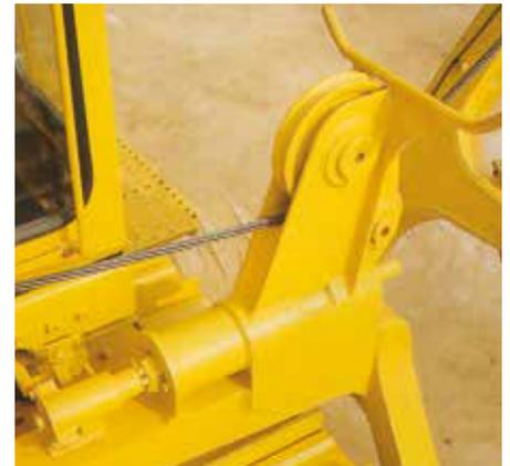
**Автоматический ограничитель максимального угла подъема стрелы:** Когда стрела доходит до предварительно установленного положения, рычаг управления стрелой автоматически возвращается в нейтральное положение. Это упрощает работу и повышает производительность.
